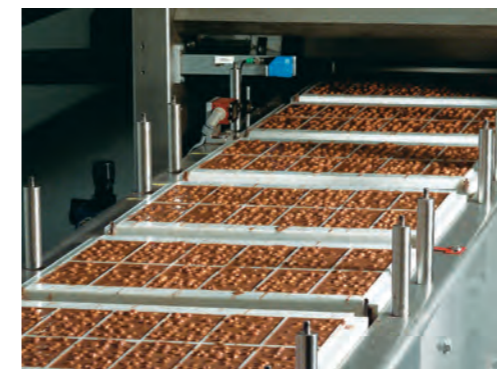
Un'occhiata in un impianto per tavolette. Le forme vengono riempite e poi scosse per eliminare le bolle d'aria, prima di entrare nel tunnel di raffreddamento.
